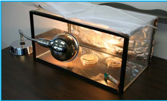
Imagen 3: Incubadora hecha de un acuario de 35 litros con cubierta de plástico abierta.
