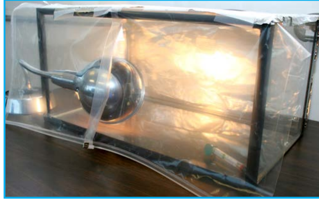
Imagen 2: Incubadora hecha de un acuario de 35 litros con cubierta de plástico cerrada.
